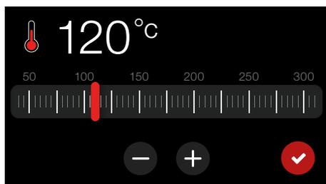
↑ Stufenweise Auswahl der Ofentemperatur.
