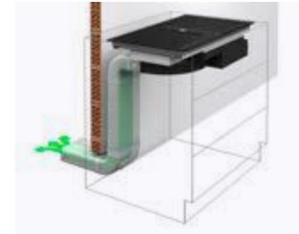
Die Installation im Abluftbetrieb ermöglicht die Montage des Muldenlüftungskochfelds mit Abluftführung nach außen. In diesem Modus muss der Luftauslass des Produkts mit der Außendurchführung des Hauses oder dem entsprechenden Lüftungskanal über spezielle Rohre verbunden werden.
