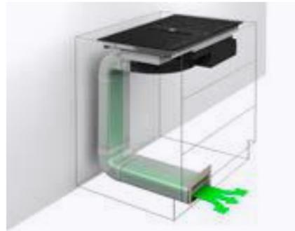
Die Installation im Umluftbetrieb ermöglicht es, Kochdünste sowie Fett- und Geruchspartikel zu filtern und die gereinigte Luft über spezielle Rohre und Gitter wieder in den Wohnraum zurückzuführen. Diese Installationsart ist besonders energieeffizient, da die Luft vollständig recycelt wird und keine Wärme nach außen verloren geht.
